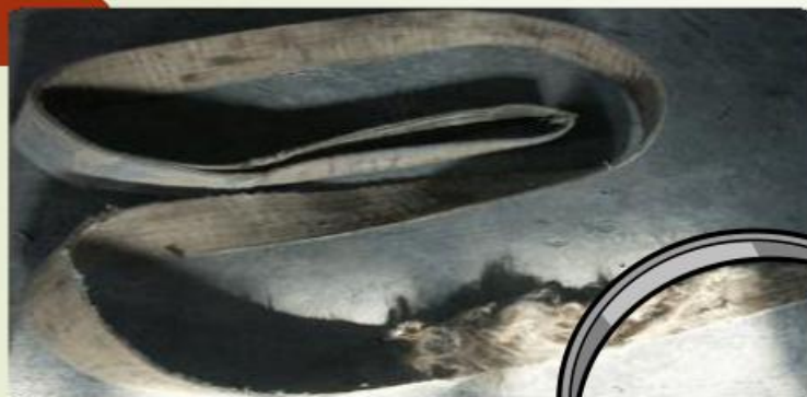
吊带已经损坏
