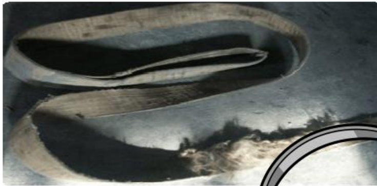
吊带已经损坏
