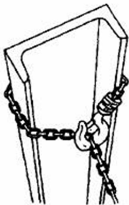
下吊钩回扣到 起重链条上起吊重物
