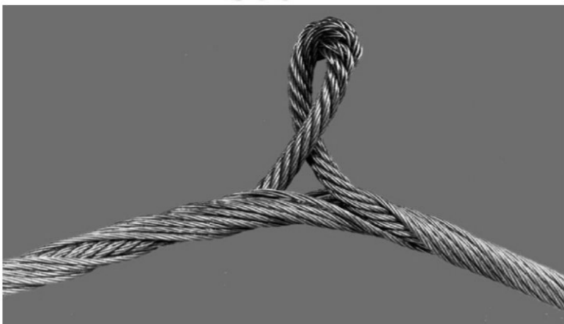
图 B.12 阻旋转钢丝绳的内层绳芯突出
