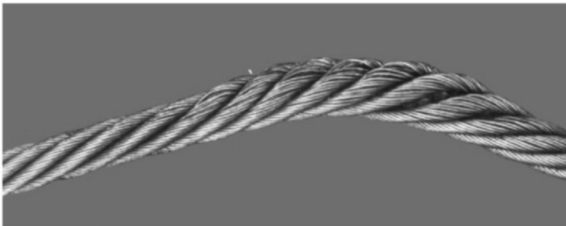
图 B.16 局部扁平(弯曲型)
