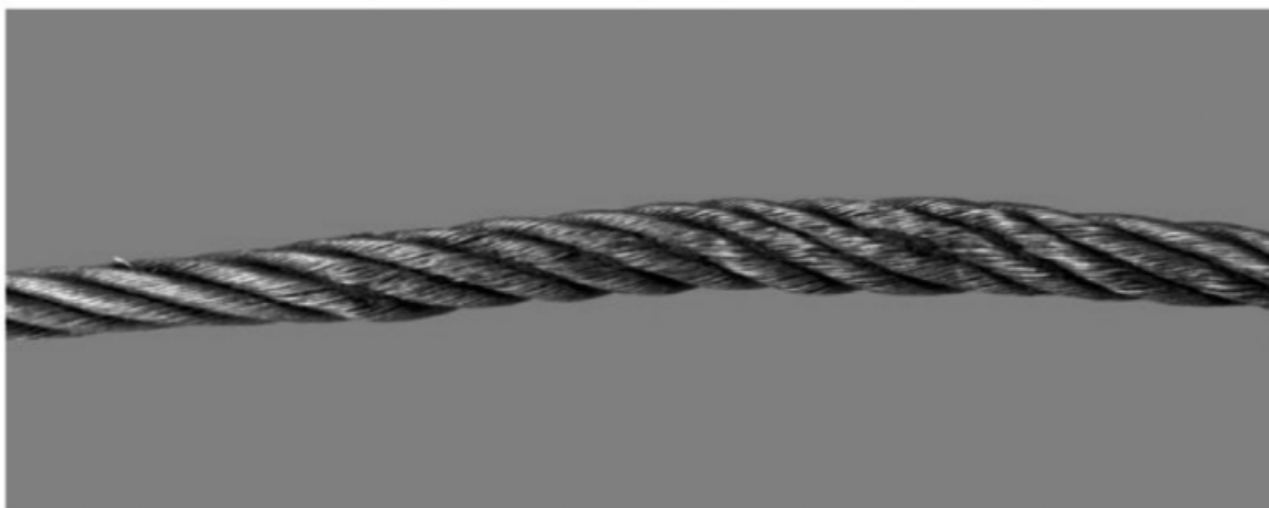
图 B.17 局部扁平(平直型)
