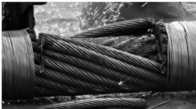
图3 大直径阻旋转钢丝绳更换和切割方法
