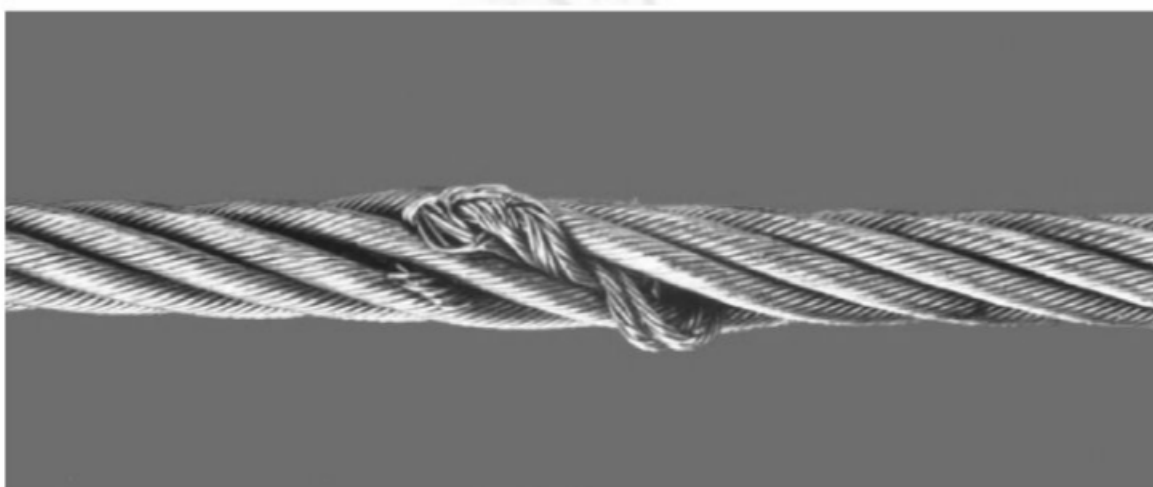
图 B.11 绳芯突出——单层钢丝绳
